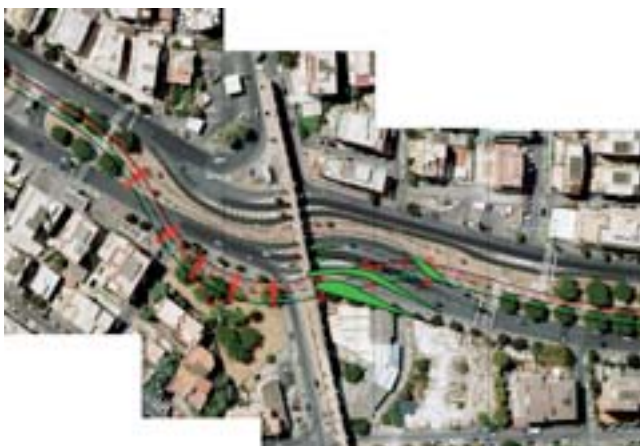
fig.3 - Studio di tracciato per il passaggio dell'Acquedotto Alessandrino (Soluz. "A"): nella planimetria si noti l'accentuato flesso delle linee d'asse delle due monorotaie affiancate; è tale da imboccare, anziché i fornici usati dalle carreggiate stradali, i fornici ubicati verso Est, aventi un'arcata a mezza quota (v. precedente fig.2); si notino altresì le posizioni, in rosso, dei telai mono-pilotis a forcella, sorreggenti le monorotaie e, in verde, le isole di progetto delimitanti le partite carribili nel piazzale Nord, in modo da contenere i pilotis, oggi costituito da una indistinta spianata di asfalto.
